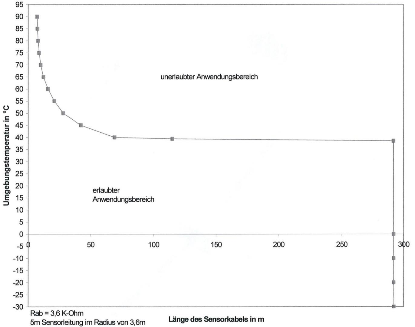
In diesem zulässigen Bereich wird bei Klasse C sicher alarmiert, wenn 5 m Sensorleitung auf 84° bis 100°C erhitzt werden.
