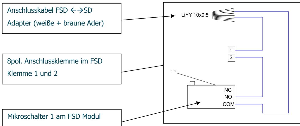
Der Mikroschalter hat eine Anschlussmöglichkeit für 4,8mm Steckkabelschuh.
