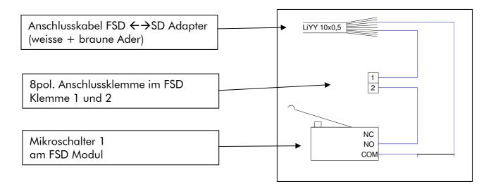
Der Mikroschalter hat eine Anschlussmöglichkeit für 4,8mm Steckkabelschuh. Die erforderlichen Leitungen sind im Lieferumfang enthalten.
