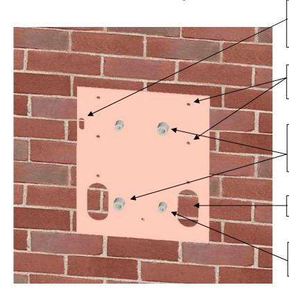
Durchbruch für Microschalter zum Abtasten der Rückwand (Abreissüberwachung)
