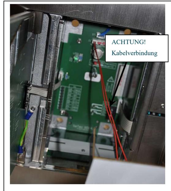
Kabelverbindung zwischen Konsole und Platine
