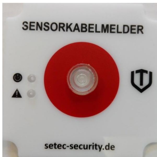
Abbildung 3 Frontplatte Auswerteeinheit SKM-03.2
