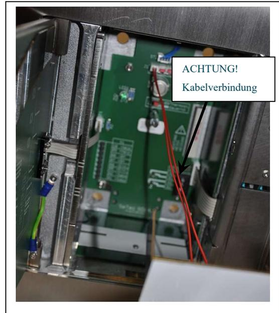
Kabelverbindung zwischen Konsole und Platine
