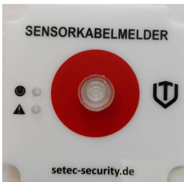
**Abbildung 3 Frontplatte Auswerteeinheit SKM-03.2**
