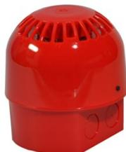
Loopversorgte, adressierte Wandsirene lässt sich als eigenständiges Gerät in jede XP95 oder Discovery Installation einsetzen. Es stehen 3 verschiedene Töne (mit DIN Ton) zur Verfügung. An diesem Busteilnehmer kann eine Loopadresse sowie bis zu 15 Gruppenadressen für synchrones Alarmieren eingestellt werden. Isolator in jeder Sirene.
