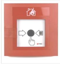
Adressierbarer Handmelder zum Anschluss an Brandmeldezentralen mit ESP Protokoll in Ringbustechnik. Jeder Melder verfügt über einem Dual-Isolator der im Kurzschlussfall die betreffenden Abschnitte abtrennt. Hergestellt nach DIN EN 54-11, mit VdS-Anerkennung.
