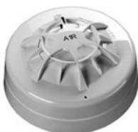
Automatischer Thermomaximalmelder. Bauart- und VdS-Zulassung. Der Melder löst bei einer max. Temperatur von 80°C aus. Mit Speicherung des Alarmsignals, Alarmsignalisierung über die integrierte Anzeige über 360° sichtbar. Kompakte, sehr flache Bauweise.
