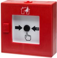
Adressierbarer Handmelder zum Anschluss an Brandmeldezentralen mit Apollo Protokoll in Ringbustechnik. Jeder Melder verfügt über einen Isolator der im Kurzschlussfall die betreffenden Abschnitte abtrennt. Hergestellt nach DIN EN 54-11, mit VdS-Anerkennung.
