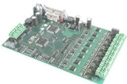
mit doppeltem Prozessor, Programmspeicher und RAM somit werden alle Systemfunktionen bei  $\mu$ P-Ausfall voll übernommen.
