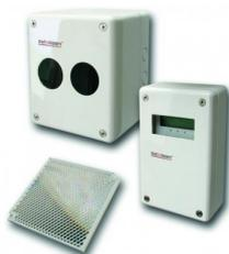
Zum Anschluss an Brandmeldezentralen mit Grenzwertgruppen in Verbindung mit dem Rücksetzmodul. Bestehend aus Sender, Empfänger und Auswerteeinheit. Zur Überwachung von großen Flächen nach dem modulierten Infrarot-Prinzip, entsprechend DIN, EN 54-12:2015 und VdS. Für Strecken von 5 bis 70 m, erweiterbar auf 160 m. Sender und Empfänger in einer Einheit.
