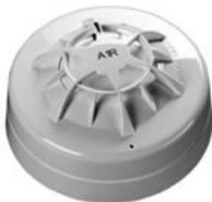
Automatischer Thermodifferenzialmelder. Bauart- und VdS-Zulassung. Der Melder löst bei einer max. Temperatur von 50°C aus. Mit Speicherung des Alarmsignals, Alarmsignalisierung über die integrierte Anzeige über 360° sichtbar. Kompakte, sehr flache Bauweise.
