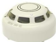
Multi Wärmemelder ATJ-EN für Ringbus mit Maximal- und Differenzialmelderfunktion. Beinhaltet Multi-Wärme-Sensoren mit Thermo-Maximal-Auswertung und Differenzialauswertung. Automatische oder Zeit-/ Ereignisabhängig schaltbar. ESP-Protokoll, daher praktisch immun gegen EMV- und Kommunikations-Störungen. Per Software kann die Empfindlichkeit den Umgebungsbedingungen angepasst werden.
