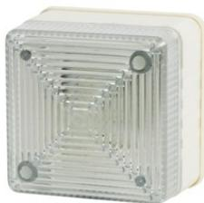
Leuchte / Blitzlampe in RGB-LED Technik, zum direkten Anschluss an Brandmeldezentralen. Das Licht wird durch RGB-LED´s erzeugt, somit sind folgende Leuchtfarben einstellbar: rot, weiß, orange, gelb, grün oder blau.
