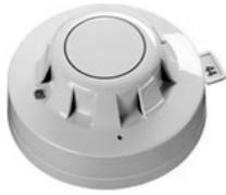
Automatischer, adressierbarer Analogmelder in Streulichttechnik. Ein Analog-/Digital-Wandler setzt die Rauchintensität in der Kammer in einen Zahlenwert um. Im gleichen Maße wie der Rauch in der Messkammer ansteigt, steigt der Zahlenwert stufenlos an. Übertragung des Zahlenwertes mind. 30-mal pro Sekunde. Geeignet für Ringbus- und/oder Stickleitungsbetrieb.
