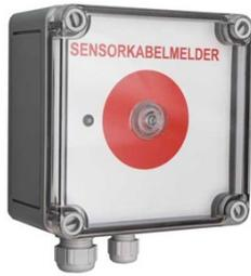
Linienförmiger Wärmemelder der Temperaturüberschreitungen über die gesamte Länge des Sensorkabels sicher detektiert. Wartungsfreundliches, anpassungsfähiges System, getrennte Alarm- und Störungssignalisierung. Über je einen potentialfreien Relaiskontakt an Grenzwertlinien oder Module anschließbar. Externe Versorgungsspannung erforderlich. Für Sensorkabellängen je Auswerteeinheit bis 300 m. Lieferung inklusive Abschlussbox.
