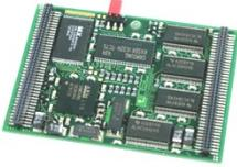
CPU-Platine P040-xx für SBZ Solution F1 - zur Schaffung eines völlig redundanten CPU-Kerns der BMZ.
