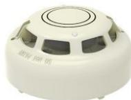
Multisensor-Ringbus-Melder ACD-EN, weiß RAL 9003, mit Dual-Channel-Technologie, CPR-zugelassen. Beinhaltet Optische, CO- und Multi-Wärme-Sensoren. Programmierbare Detektionsalgorithmen (Betriebsart TM). 4 Modi automatisch oder Zeit- oder Ereignis abhängig schaltbar. ESP-Protokoll, daher praktisch immun gegen EMV- und Kommunikations-Störungen. Mit Flat-Response-Technologie zur optimierten Rauchdetektion.
