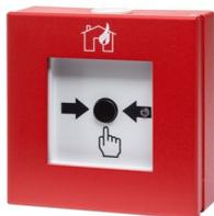
Adressierbarer Handmelder zum Anschluss an Brandmeldezentralen mit Apollo Protokoll in Ringbustechnik. Jeder Melder verfügt über einen Isolator der im Kurzschlussfall die betreffenden Abschnitte abtrennt. Hergestellt nach DIN EN 54-11, robustes Metallgehäuse mit seitlicher Öffnungsmechanik.
