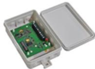
Adressierbares Modul mit überwachtem Eingang und Spannungsausgang 14 V DC. Ausgang variabel von 4 bis 20 mA. Versorgung direkt aus dem Ring ohne externe Quelle.
