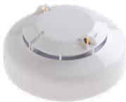
Der SOTERIA Wärmemelder bietet zwei Wärmesensoren die seitlich am Meldergehäuse angeordnet sind, um eine gute Wärmedetektion aus allen Richtungen zu gewährleisten.
