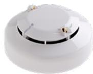
Der SOTERIA Mehrfachsensor O/T verwendet die neue optische Sensortechnologie PureLight™, um Rauchpartikel in der Melderkammer zu detektieren und verfügt zusätzlich über zwei Wärmesensoren. Er kann in unterschiedlichen Betriebsmodi (Empfindlichkeitsstufen) betrieben werden, beispielsweise als optischer Rauchmelder, Wärmemelder der Klasse A1R oder als Kombimelder mit verschiedenen Empfindlichkeiten.
