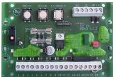
Elektronische Leiterplatte als universelles Interface zwischen der Brandmeldezentrale und dem Feuerwehrschlüsseldepot, mit eigenständiger Überwachung des SD und der Übertragungseinrichtung. Nach DIN, VDE und mit VdS-Anerkennung.
