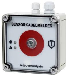
Linienförmiger Wärmemelder der Temperaturüberschreitungen über die gesamte Länge des Sensorkabels sicher detektiert. Wartungsfreundliches, anpassungsfähiges System, getrennte Alarm- und Störungssignalisierung. Über je einen potentialfreien Relaiskontakt an Grenzwertlinien oder Module anschließbar. Externe Versorgungsspannung erforderlich. Für Sensorkabellängen je Auswerteeinheit bis 300 m.
