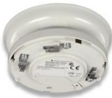
Ringbus-Sockelsirene YBO-BS(WHT), 98dB, weiß RAL 9003, zum Einsatz im Meldersockel. Stromversorgung durch Ringbus. Mit ESP-Protokoll, daher praktisch immun gegen EMV- und Kommunikations-Störungen. Adressierbar entweder automatisch durch Zentrale oder durch Handprogrammiergerät. 10 Lautstärken an der BMZ einstellbar. 51 verschiedene Tonarten, u.a. der DIN-Ton und ISO8201. Praktisch kein Installationsaufwand.
