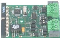
Zum Einstecken in Zentralrechner. Anschluss an das Multi-Master-Kommunikationssystem mit maximal 128 Teilnehmern. Redundant ausführbar durch zwei separate Steckplätze in der BMZ.
