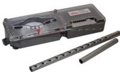
Zur Aufnahme von Rauchmelder der Serie 65, inklusive Meldersockel und Relaisplatine. Es wird an Luftkanäle angebaut und ermöglicht die Entnahme einer Luftprobe, die über das Lufteintrittsrohr in die Probenkammer und dann in den Melder gelangt. Lieferung ohne Melder.
