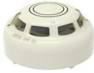
Multi Wärme-Ringbusmelder ATJ-EN(WHT)SCI, weiß RAL 9003, mit integrierten Trenner. Beinhaltet Multi-Wärme-Sensoren mit Thermo-Maximal-Auswertung und Differenzialauswertung. Automatisch oder Zeit-/Ereignisabhängig schaltbar. Mit ESP-Protokoll, daher praktisch immun gegen EMV- und Kommunikations-Störungen. Per Software kann die Empfindlichkeit den Umgebungsbedingungen angepasst werden.
