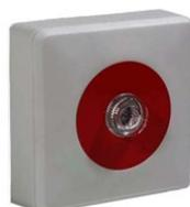
Zur Anzeige und schnellen Lokalisierung von ausgelösten, nicht sichtbar montierten Brandmeldern, nach DIN, EN54 und VdS. Verwendbar zur ap oder Dosenmontage, zwei leuchtstarke LEDs hinter klarer, runder Anzeigekalotte auf rotem Punkt nach DIN.
