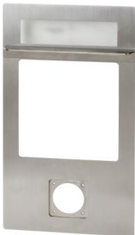
Zum Anbau an den Funktionsblendrahmen als Wetterschutz für das Feuerwehrsicherheitstechnik SD04.2. Das Dach wird durch zwei Bohrungen und mit Hilfe von 2x M4 Muttern an den Funktionsblendrahmen befestigt. Mit einer Neigung des Daches von 10°, gewährleisten wir einen optimalen Abfluss von Regen- bzw. Spritzwasser.
