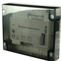
Eingangsmodul CHQ-SZM2(SCI) Smart Fix mit 1 Meldegruppe, "loop-powered" / inkl. IP54-a.P.-Gehäuse. Ringbusmodul mit integriertem Dual-Isolator. Eine Meldegruppe für konventionelle Melder, überwacht auf Kurzschluss und Drahtbruch. Zum Anschluss von Fremdmeldern oder von bis zu 6 Grenzwert CDX oder ein UV-Flammenmelder. Mit ESP-Protokoll, daher praktisch immun gegen EMV- und Kommunikations-Störungen. Durch sehr geringe Stromaufnahme direkt vom Loop zu versorgen. Low Power Modus bei Netzausfall.
