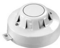
Automatischer, adressierbarer Analogmelder in Streulichttechnik. Ein Analog-/Digital-Wandler setzt die Rauchintensität in der Kammer in einen Zahlenwert um. Es stehen fünf Empfindlichkeitsstufen zur Verfügung. Unterschiedliche Einstellungen für Tag- bzw. Nachtbetrieb können gewählt werden.
