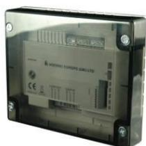
Zweifach Eingangsmodul CHQ-DIM2(SCI) "Smart Fix" mit 2 Kontakteingängen, mit Dual-Isolator, für Ringbus "loop-powered". Beide Eingänge werden unabhängig voneinander ausgewertet, für potenzialfreie Kontakte wie. Relaiskontakte, Sprinkler etc.. Mit ESP-Protokoll, daher praktisch immun gegen EMV- und Kommunikations-Störungen. Durch sehr geringe Stromaufnahme direkt vom Loop zu versorgen. Low Power Modus bei Netzausfall.
