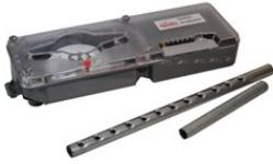
Zur Aufnahme von Rauchmelder der Serie XP95 bzw. Discovery, inklusive Meldersockel und Anschlussplatine. Es wird an Luftkanäle angebaut und ermöglicht die Entnahme einer Luftprobe, die über das Lufteintrittsrohr in die Probenkammer und dann in den Melder gelangt. Lieferung ohne Melder. Das Luftkanalmeldergehäuse selbst hat keine VdS oder DIBt Zulassung, der einzusetzende Optische Rauchmelder ist jedoch VdS zugelassen!
