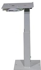
Melderkonsole für automatische Brandmelder, die Befestigung erfolgt am Fussboden. Die Höhe ist durch auseinanderziehen variabel von 320 mm bis 420 mm anzupassen. Der obere Teil zur Befestigung des Meldersockels kann um 130° nach oben geklappt werden.
