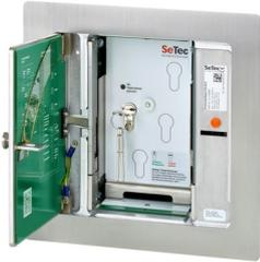
Zum Anschluss an alle Brandmeldezentralen in Verbindung mit einem Schlüsseldepot-Adapter z.B. SDA3. Einbau von Innentüren aller zugelassenen Feuerweherschließungen möglich. Komplett aus nicht rostendem Material. Blendrahmen und Außentüre aus V2A Edelstahl. Lieferung ohne Innentür, ohne Anschlusskabel, inkl. geregelter Heizung, Putzhülle und Blendrahmen.
