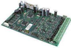
mit doppeltem Prozessor, Programmspeicher und RAM - somit werden die Systemfunktionen bei Mikroprozessor-Ausfall voll übernommen
