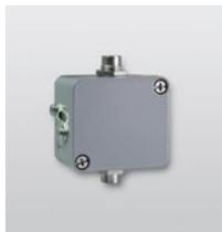
Die Antennen-Trennbox dient zum galvanisch getrennten Anschluss einer im Freien montierten GSM Antenne an das GSM-Modul einer UE. Alle Anschlüsse der UE bleiben dadurch frei von Erdpotenzial. Gleichzeitig dient die Trennbox zum Schutz der UE vor Überspannungen auf dem Antennenanschluss.
