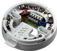
Sockelisolator zum Abtrennen einzelner Linienabschnitte im Kurzschlussfall. Bei Kurzschluss, d.h. bei Trennen der Linie, leuchtet eine gelbe Kontrollanzeige. Passend für alle adressierbaren Melder (Serie XP95 und Discovery).
