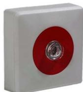
Adressierte Anzeige zur Lokalisierung von ausgelösten, nicht sichtbar montierten Brandmeldern, nach EN54. Verwendbar zur aP oder Dosenmontage, zwei leuchtstarke LEDs hinter klarer, runder Anzeigekalotte auf rotem Punkt nach DIN. Freie Zuordnung zu Meldern oder Gruppen durch Programmierung an der Zentrale.
