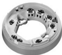
Socket für alle Grenzwertmelder der Serie ORBIS, zusätzlich mit Relais. Ein potentialfreier Wechsler wird durch den Ausgang der Parallelanzeige angesteuert und bis zum Rücksetzen gehalten. Flache Ausführung.
