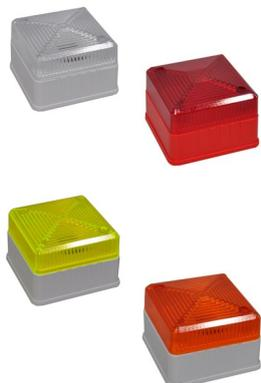
Leuchte / Blitzlampe in RGB-LED Technik, zum direkten Anschluss an Brandmeldezentralen. Das Licht wird durch RGB-LED´s erzeugt, somit sind folgende Leuchtfarben einstellbar: rot, weiß, orange, gelb, grün oder blau. Ein zusätzliches Feature dieser Leuchte sind die 5 unterschiedlichen Blitz/Leuchtmuster wie z.B. Dauerlicht oder Doppelblitz.
