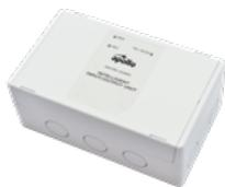
Das intelligente Ein-/Ausgangsmodul ermöglicht die Überwachung von einem oder mehreren Schliesserkontakten die an eine 2-Drahtleitung angeschlossen sind und stellt einen Relais-Wechselkontakt zur Verfügung. Das Modul ist kompatibel zu den digitalen Apollo Kommunikationsprotokollen XP95, Discovery und CoreProtocol.
