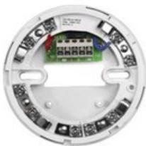
Socket für alle Grenzwertmelder der Serie 65, zusätzlich mit Relais. Ein potentialfreier Wechsler wird durch den Ausgang der Parallelanzeige angesteuert und bis zum Rücksetzen gehalten. Flache Ausführung.
