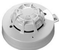
In einem Gehäuse ist sowohl ein photoelektronischer Rauchmelder als auch ein Thermo-Diff.-Melder vereinigt. Es stehen fünf Empfindlichkeitsstufen zur Verfügung. Unterschiedliche Einstellungen für Tag- bzw. Nachtbetrieb können gewählt werden. Der Mehrfachsensoren kann multifunktional verwendet werden.
