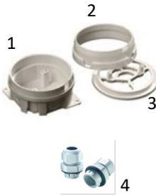
Der Feuchtraumsockelzusatz(1) ist ein Gerät, das Sockel, Sirenensockel und Kombisockel gegen Eindringen von Wasser oder anderer Flüssigkeiten schützt. Er wird an die Decke geschraubt und ist zur Aufnahme einer Vielfalt von Apollo-Sockeln geeignet.
