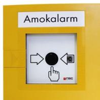
Adressierbarer Handmelder zum Anschluss an Brandmeldezentralen mit ESP Protokoll in Ringbustechnik. Jeder Melder verfügt über einem Dual-Isolator der im Kurzschlussfall die betreffenden Abschnitte abtrennt. Hergestellt nach DIN EN 54-11, mit VdS-Anerkennung.
