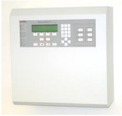
Modular aufgebaute, moderne Brandmeldezentrale für Ringbus- und Grenzwerttechnik. Vorgerüstet für 2 bis 12 Ringe oder 8 bis 72 Grenzwertlinien. Kompatibel zu Hochiki CDX, ESP und Apollo Serie 65, XP95 und Discovery.
