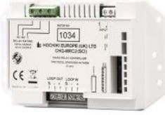
High-Power I/O-Modul CHQ-MRC2(SCI) mit Steuerrelais, über Eingang und Dual-Isolator, "loop-powered". Program Relais (5A / 230V AC). Zusätzlicher Eingang für Alarm und Störung, überwacht auf Kurzschluss und Drahtbruch. Überwachung abschaltbar. Mit ESP-Protokoll, daher praktisch immun gegen EMV- und Kommunikations-Störungen. Direkt vom Loop zu versorgen. Low-Power Modus bei Netzausfall.
