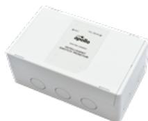
Das intelligente Schaltüberwachungsmodul wurde entwickelt um den Status von einem oder mehreren einpoligen, potentialfreien Schaltkontakten, die über eine 2-Drahtleitung angeschlossen sind, zu überwachen. Durch eine aktivierbare Verzögerung der Statusmeldung eignet sich das Modul zur Überwachung von Flüssigkeitsschaltern. Das Modul ist kompatibel zu den digitalen Apollo Kommunikationsprotokollen XP95, Discovery und CoreProtocol.
