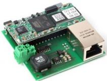
Das Web-Server-Modul erlaubt den Zugriff auf die SBZ F1 oder F2 direkt über das Internet ohne dass hierfür zusätzliche Software benötigt wird.
