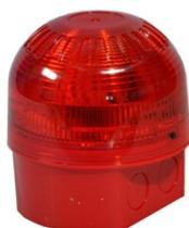
Loopversorgte, adressierte Wandsirene/Blitzlampe lässt sich als eigenständiges Gerät in jede XP95 oder Discovery Installation einsetzen. Es stehen 3 verschiedene Töne (mit DIN Ton) zur Verfügung. An diesem Busteilnehmer kann eine Loopadresse sowie bis zu 15 Gruppenadressen für synchrones Alarmieren eingestellt werden.
