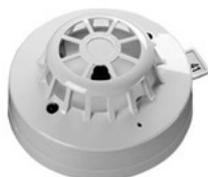
Automatischer, adressierbarer Analogmelder mit NTC-Meßwiderstand. Die gemessene Temperatur entspricht genau dem an die BMZ übertragenen Analogwert. Es stehen fünf Empfindlichkeitsstufen zur Verfügung. Unterschiedliche Einstellungen für Tag- bzw. Nachtbetrieb können gewählt werden. Nach Klasse A1R, A2, A2S sowie CR und CS Bereiche.
