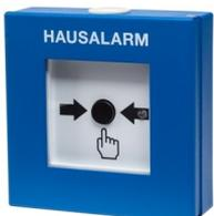
Adressierbarer Handmelder zum Anschluss an Brandmeldezentralen mit Apollo Protokoll in Ringbustechnik. Jeder Melder verfügt über einen Isolator welcher im Kurzschlussfall die betreffenden Abschnitte abtrennt. Hergestellt nach DIN EN 54-11, robustes Metallgehäuse mit seitlicher Öffnungsmechanik.
