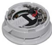
Adressierte Sockelsirene mit Sockel und Isolator. Auf die sehr flache Plattform ist direkt ein Apollo Meldersockel aufgeschraubt. Als Tonart steht der genormte DIN Ton zur Verfügung.
