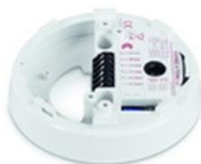
Montageplattform mit integrierter Niedrigstrom-Sirene. Auf die sehr flache Plattform kann direkt ein Meldersockel mit einem Durchmesser von 100 mm aufgeschraubt werden. 32 verschiedene Tonarten und 3 Lautstärkestufen, mittels DIP-Schalter einstellbar (inklusive DIN-Ton).
