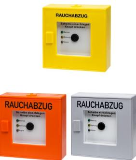
Zum Anschluss an verschiedene RWA Zentralen. Drei einzeln ansteuerbare LED´s, innenliegender Rücksetz-Taster, nicht bedienbar bei geschlossenem Gehäuse. Vorgerüstet für den Betrieb an RWA Zentralen mit Alarm / Endwiderstandskombination  $R_a = 2,2 \text{ KOhm}$  /  $R_e = 10 \text{ KOhm}$ .
