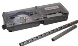
Zur Aufnahme von Rauchmelder der Serie ORBIS, inklusive Meldersockel und Relaisplatine. Es wird an Luftkanäle angebaut und ermöglicht die Entnahme einer Luftprobe, die über das Lufteintrittsrohr in die Probenkammer und dann in den Melder gelangt.
