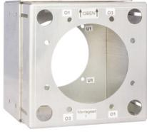
Dieser Ausgleichsadapter wurde speziell für die Montage von SeTec FSD´s in Dämmfassaden entwickelt. Der Adapter besteht aus 2 Teilen. Teil 1 wird auf die massive Wand des Objekts geschraubt. Teil 2 wird hinein geschoben bis die gewünschte Einbautiefe für das FSD erreicht ist.
