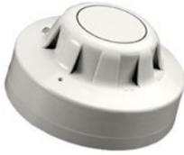
Automatischer Grenzwertmelder mit Gruppenidentifizierung nach dem Streulicht-Prinzip, Bauart- und VdS-Zulassung. Mit Speicherung des Alarmsignals, Alarmsignalisierung durch rot leuchtende LED. Kompakte, sehr flache Bauweise.
