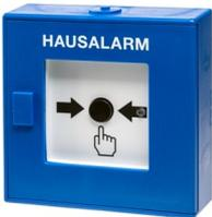
Adressierbarer Handmelder zum Anschluss an Brandmeldezentralen mit Apollo Protokoll in Ringbustechnik. Jeder Melder verfügt über einen Isolator der im Kurzschlussfall die betreffenden Abschnitte abtrennt. Hergestellt nach DIN EN 54-11, mit VdS-Anerkennung.
