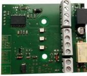
für die Verwendung zusammen mit einer Apollo Sounder Control Unit. Die Platine stellt die Alarmierung auch im Falle einer Loopunterbrechung nach Aktivierung der Signalgeber sicher.
