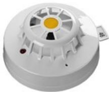
Automatischer, adressierbarer Analogmelder mit NTC-Messwiderstand. Die gemessene Temperatur entspricht dem an die BMZ übertragenen Analogwert. Übertragung des Analogwertes mind. 30-mal pro Sekunde an die SBZ. Nach EN 54 Teil 5 in Klasse 2 einzustufen.
