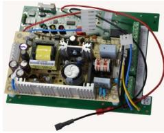
Diese Notstromversorgung findet Ihren Platz in der linken, leicht zu öffnenden Kammer des FSM Zusatzgehäuses. Die Platine gewährleistet bei Netzausfall den reibungslosen Betrieb des FSM. Auch im Havariefall hat die Feuerwehr jederzeit die Möglichkeit den FSM zu öffnen.
