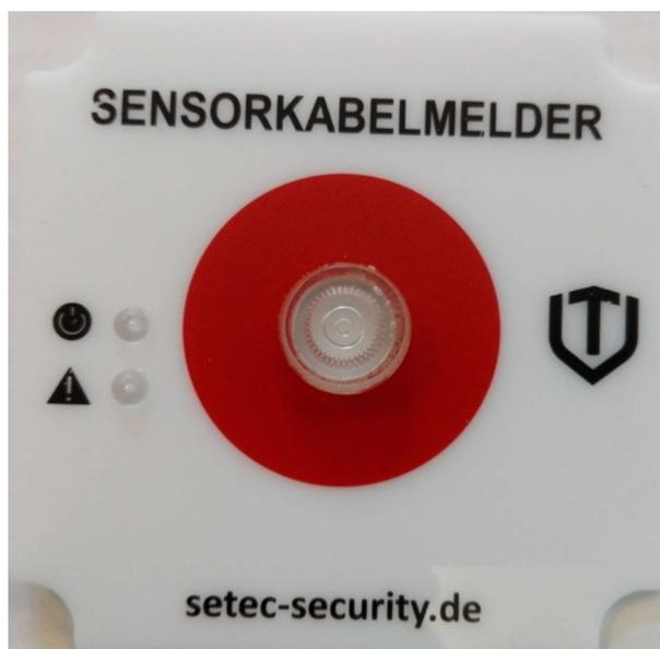
**Abbildung 3 Frontplatte Auswerteeinheit SKM-03.2**
